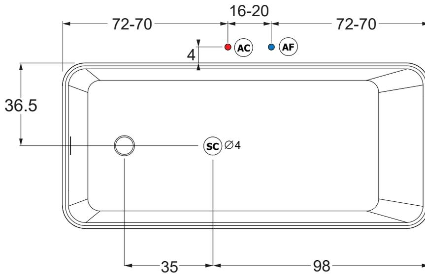
Allaccio acqua calda nel caso di vasca provvista di rubinetteria **AC** Hot water connection should the bathtub be fitted with taps
